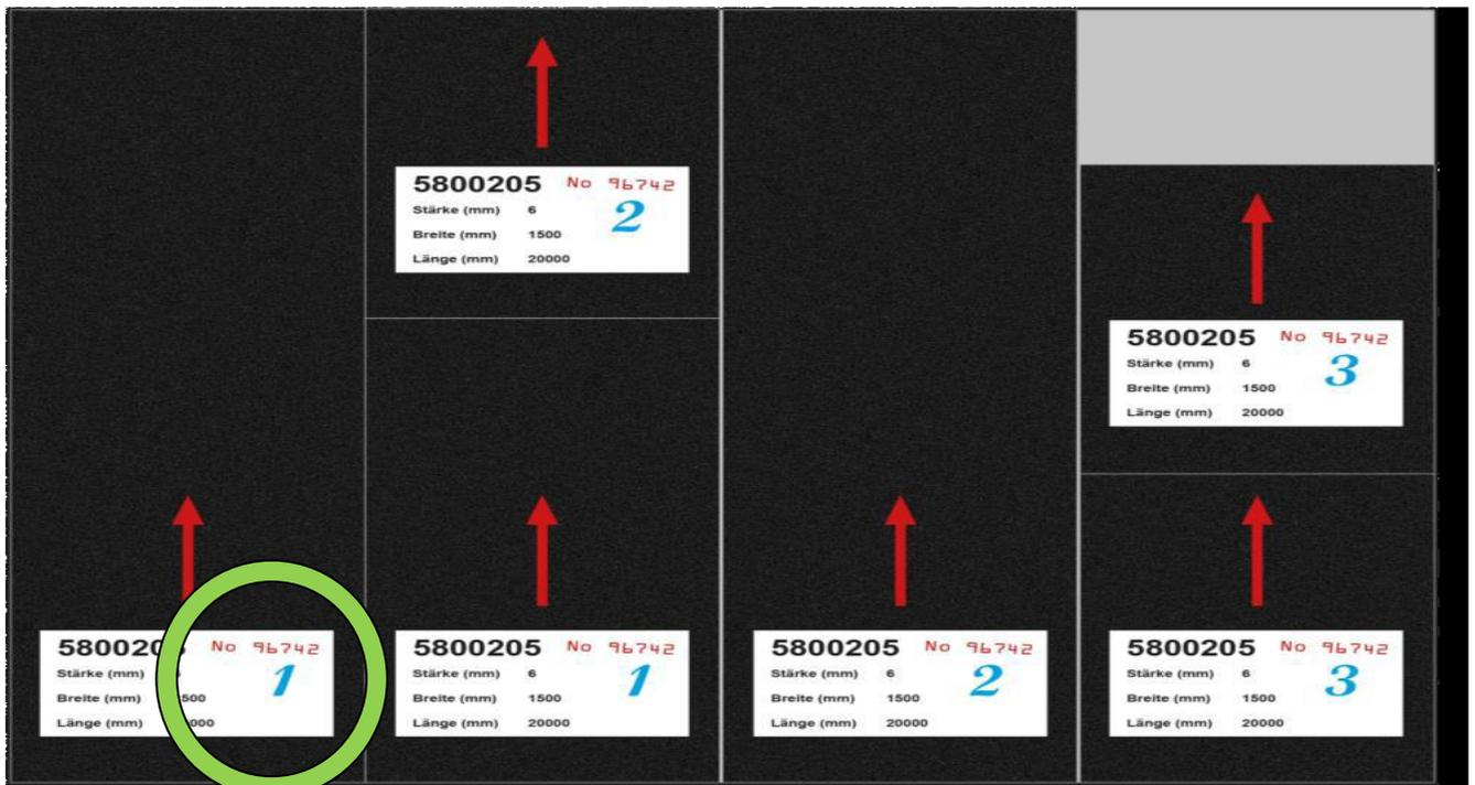
Verwenden Sie chargengleiche Rollen und verlegen diese fortlaufend nach der Rollennummer.
